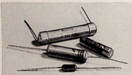
Verschiedene Ausführungen von Resistorwiderständen. Rechts ein kaptenloser Spezialwiderstand für Höchstfrequenzen, davor ein tropenfester Widerstand mit Farbbringkennzeichnung, ganz vorne ein 0,5-W-Schichtwiderstand mit axialen Anschlußdrähten und dadurch sehr geringen Abmessungen
